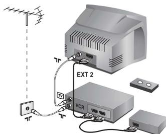
Κάνετε τις συνδέσεις που φαίνονται στο διπλανό σχέδιο. Χρησιμοποιήστε ένα καλώδιο σύνδεσης ενεωβύβιμα καλής ποιότητας.
