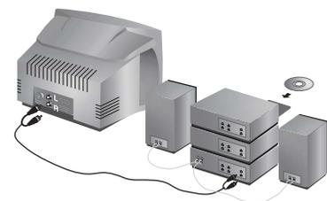
Zum Anschluß an eine HiFi-Anlage benutzen Sie ein Audio-Verbindungskabel. Verbinden Sie die Anschlüsse "L" und "R" des Fernsehgerätes mit einem Eingang "AUDIO IN" "L" und "R" des Verstärkers.
