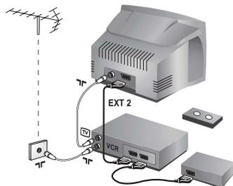
Eseguire i collegamenti necessari. Utilizzare un cordone di collegamento (presa scart) di tipo europeo di buona qualità. Se il vostro videoregistratore non ha una presa scart, l'unico collegamento possibile rimane quello per mezzo dell'antenna. Bisognerà quindi cercare il segnale di prova del vostro videoregistratore e attribuirgli il numero di programma 0 (vedi capitolo "memorizzazione manuale" a pag. 6). Per far apparire l'immagine del videoregistratore, premere 0.
