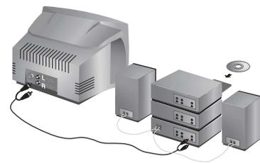
Pour le raccordement à une chaîne Hi-fi, utilisez un cordon de liaison audio et connectez les sorties "L" et "R" du téléviseur à une entrée "AUDIO IN" "L" et "R" de la chaîne Hi-fi.
