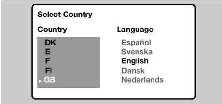
Wenn das Menü nicht angezeigt wird, halten Sie die Tasten  $\blacktriangleleft$ - und  $\blacktriangleright$  des Fernsehgeräts 5 Sekunden lang gedrückt. Daraufhin wird das Menü angezeigt.
