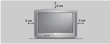
Plaats uw TV toestel op een stevige en stabiele ondergrond en laat rondom het toestel een ruimte vrij van tenminste 5 cm. Om gevaarlijke situaties te voorkomen dient u op het toestel geen voorwerp te zetten dat dekkend (kleedje) of vol met water (vaas) is of dat warmte ontwikkelt (lamp). Het TV toestel mag niet aan water worden blootgesteld.
