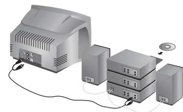
Om een hi-fi systeem aan te sluiten, dient u een audiokabel te gebruiken en de "L" en "R" uitgangen van het TV toestel aan te sluiten op de ingangen "AUDIO IN" "L" en "R" van de versterker van uw hi-fi.
